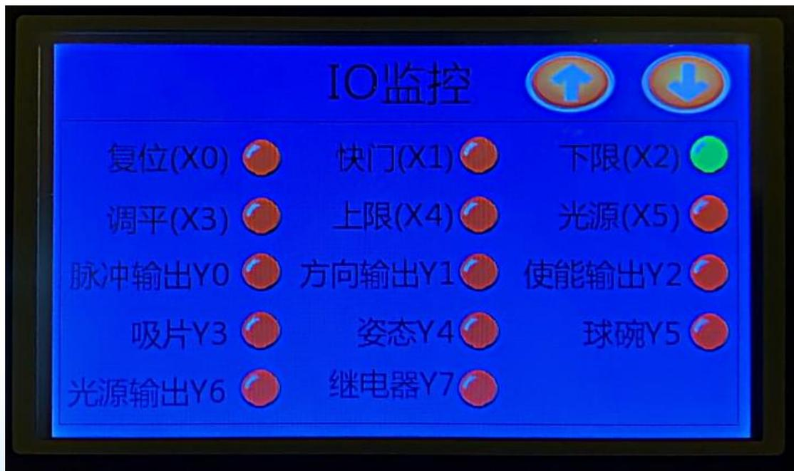
图 6 电气 IO 调试监控
