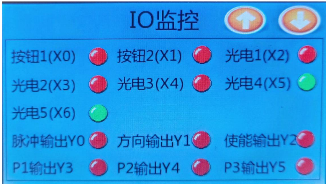
图 8 电气 IO 调试监控
